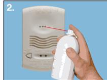
2. Pulverizar agente de CO en spray sobre el detector.
