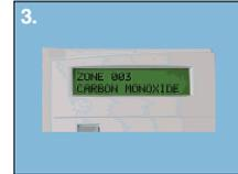
3. Verificar la detección de CO en el panel de control. El detector saldrá automáticamente del modo de alarma RealTest luego de 20-60 segundos.
