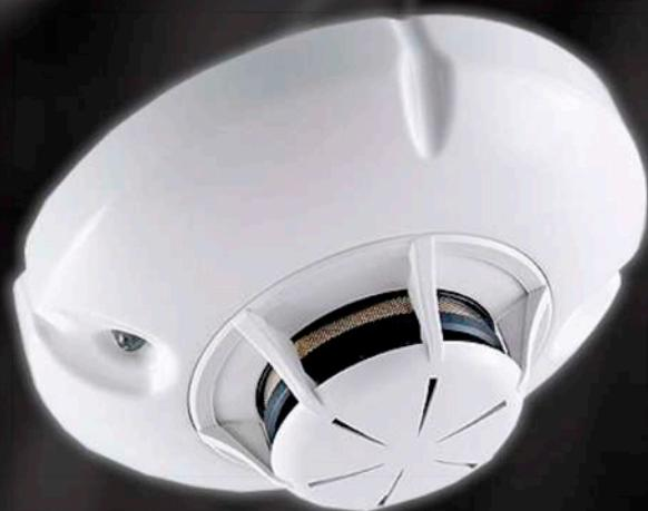
Detector Óptico Térmico convencional modelo FD8060. Posee un sistema de señalización en alarma formado por 2 pilotos indicadores de acción de bajo consumo, sincronizados de forma intermitente, para discriminar la activación del detector.
