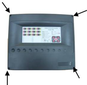
1. Extraiga los 4 tornillos de fijación de la tapa y consérvelos en un lugar seguro y protegido para su posterior reinstalación.
