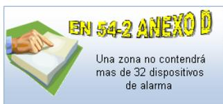
Dispone de 2 hasta 12 zonas de detección convencional (según modelo) que admiten hasta 32 detectores continuamente supervisados mediante resistencia de final de línea. Dispone de hasta 4 modos de funcionamiento de las zonas configurables independientemente.
